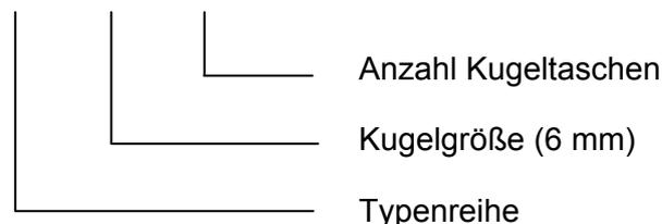
Kugelkäfig als Meterware, befüllt mit Kugeln  $\varnothing$  6 mm aus korrosionsbeständigem Stahl (SS)
