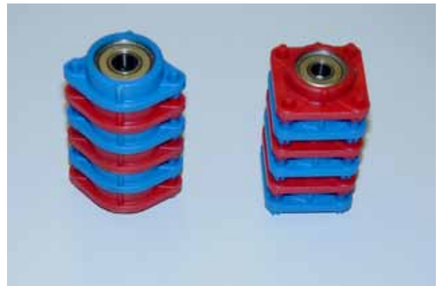
Gestapelt für die Zuführung automatische Montage mit Roboter
